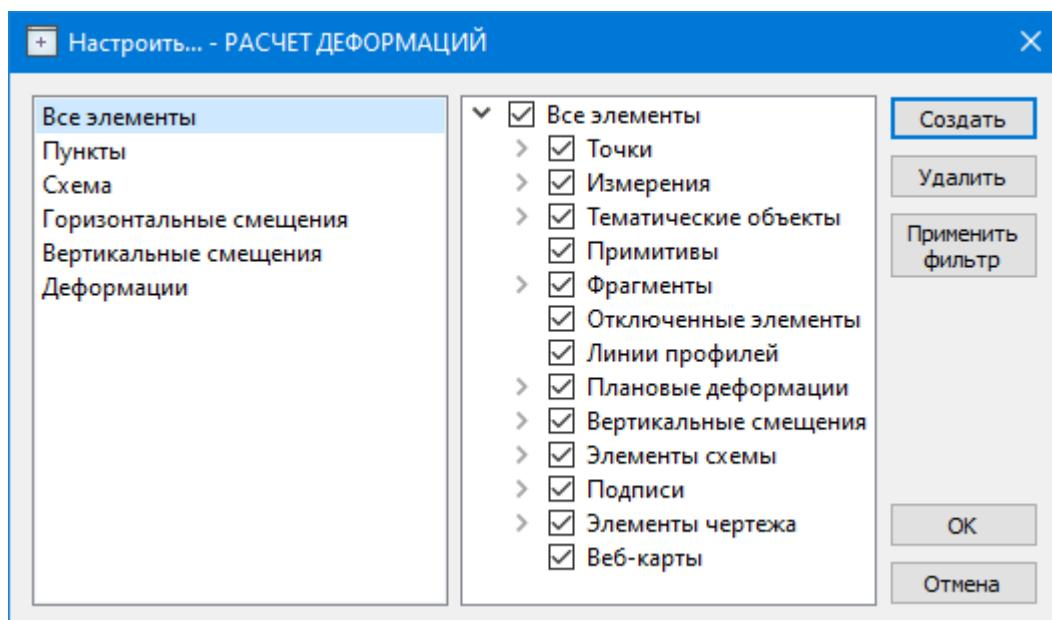
Кнопка **Создать** создает новый фильтр, имя фильтра редактируется. Отметьте флажками элементы, которые должны будут отображаться в окне План при выборе этого фильтра.
