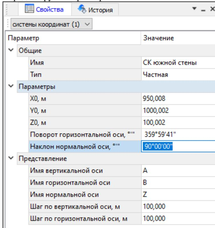
Для блока **Южная стена** выберите систему координат СК Южной стены.
