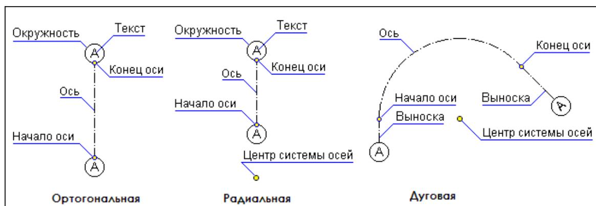
Дуговые оси могут быть замкнутыми (окружность) и незамкнутыми (дуга). Если точки начала и конца оси совпадают, получается замкнутая ось.
