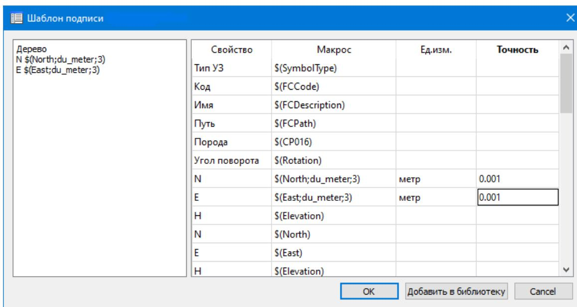
В колонке "**Свойство**" прописаны все доступные свойства объекта для подписи, в "**Макрос**" записаны переменные-макросы (выводят значения), в "**Ед.изм.**" хранятся все доступные единицы измерения для переменной и в колонке "**Точность**" настраивается точность представления переменной.
