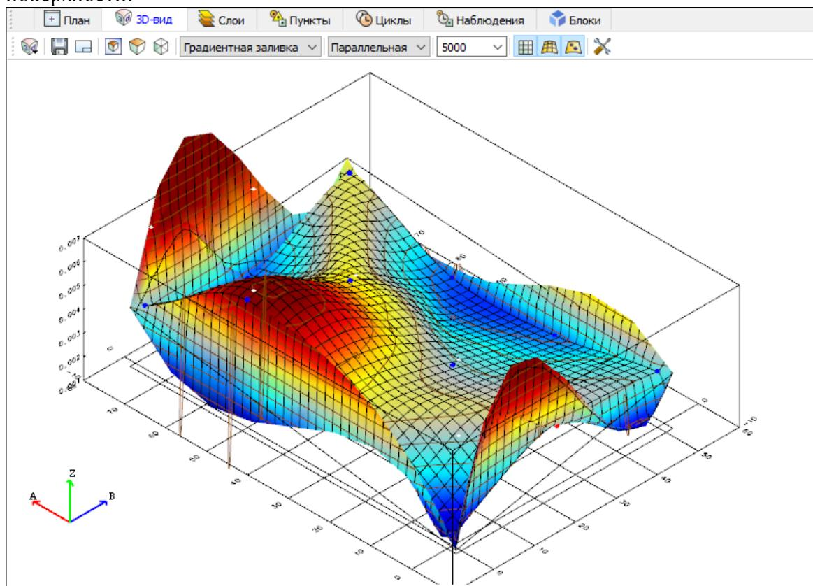
Помимо самой поверхности в окне могут отображаться координатная сетка, координационные оси, пункты.
