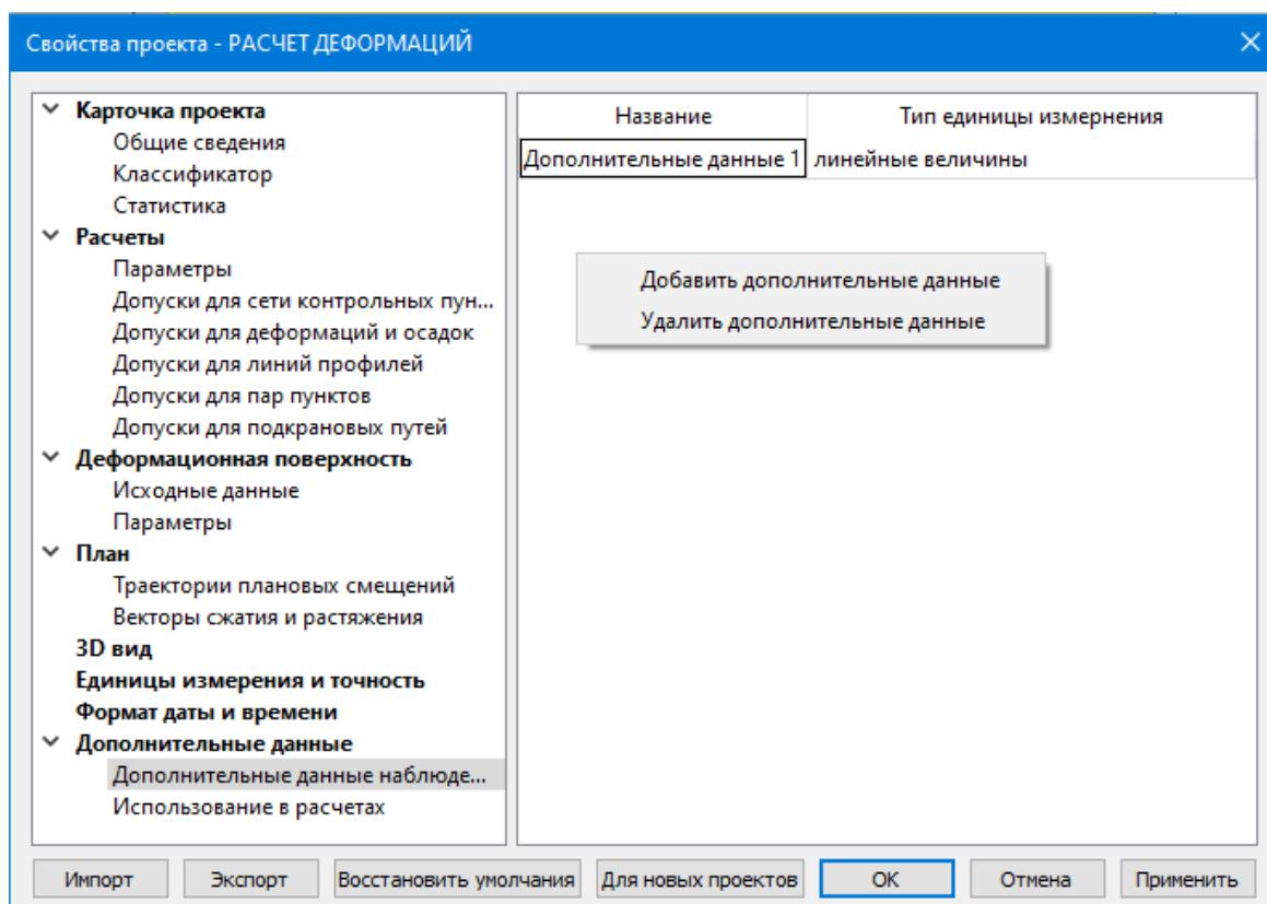
Добавление поля в этом разделе добавляет возможность импорта соответствующих данных по шаблону наряду с координатами и высотой, добавляет соответствующие поля в **Наблюдения** (в таблицу Наблюдений и в свойства элемента).
