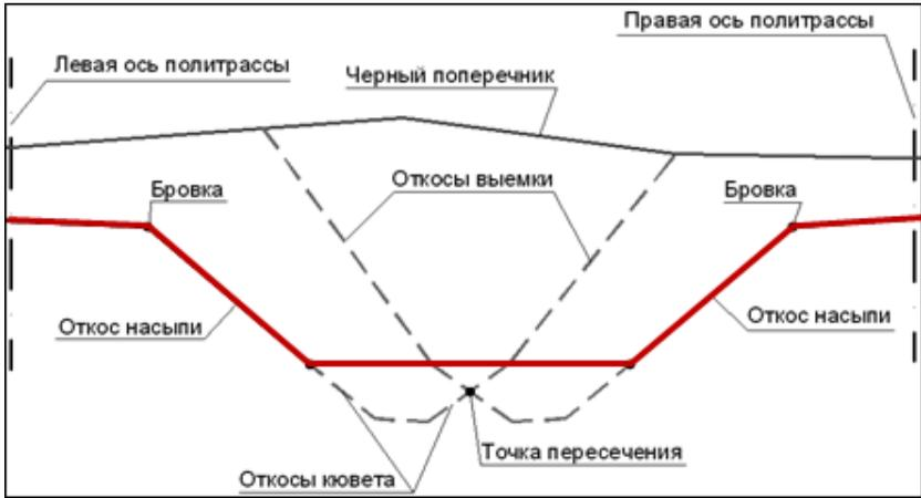
Система также контролирует *расстояние между точками выхода откосов выемки* на черный поперечник:
