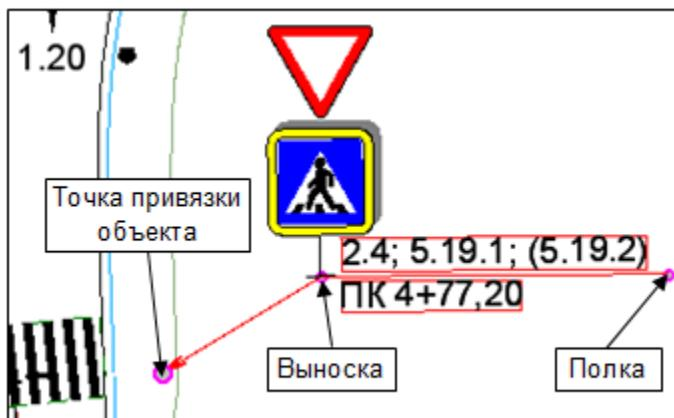
В команде **Подпись линейных объектов и разметки** положение подписи можно уточнить в графической области с помощью управляющих точек - методы **Создать** и **Редактировать**, а также в окне параметров - метод **Редактировать**.
