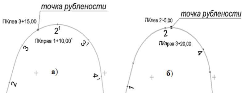
Рис. а) - при дублировании ПК к стандартному обозначению ПК добавляются дополнительные цифры в подписях ПК.
