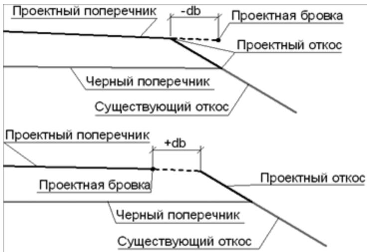
При получении точки пересечения, сравниваются  $\pm db$  и *заложение откоса* с параметрами, принятыми на интервале, - см. [окно параметров](#).
