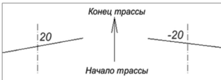
Для интервалов ИПП с двускатным профилем знак уклона задается всегда положительным, при этом ось дороги расположена выше кромок.
