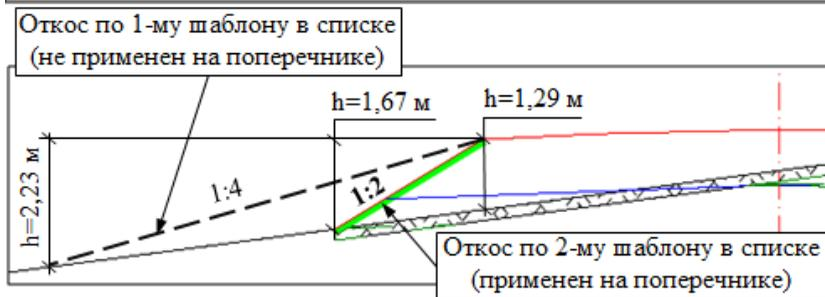
Откос по шаблону, первому в списке шаблонов, на данном поперечнике не применялся, т. к. разница в отметках равна **2,23 м**, а это больше, чем заданная высота (2,0 м) + максимальное приращение (10% = 0,2 м). В итоге, откос построен по второму шаблону.
