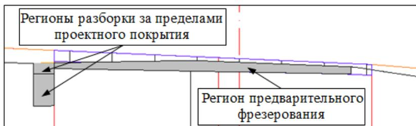
Если толщины определяются из 3D-модели существующей дороги, то и фрезерование, и разборка будут выполнены на всю толщину указанных слоев. Изменить толщину фрезерования можно в окне параметров, после выбора точки (метод **Параметры точки или интервала**) или в таблице на вкладке **Точки** (метод **Редактировать в таблице**).
