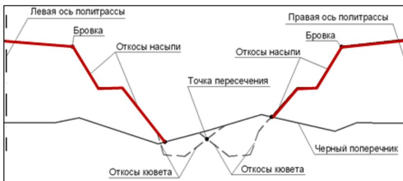
**Б)** Для обоих поперечников в выемке или для одного поперечника в насыпи, а второго в выемке – конечные точки откосов насыпи соединяются прямой:
