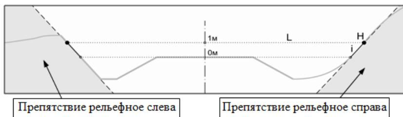
Определение рельефных препятствий происходит автоматически в графах **Препятствия рельефные слева** и **Препятствия рельефные справа** сетки **Расстояния видимости**.
