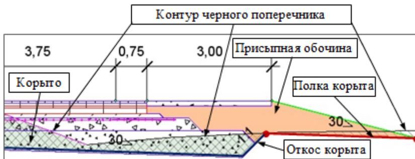
В определенных условиях (например, **не** найдено пересечение откоса корыта с контуром проектного поперечника) может быть построена прикюветная полка - от границы проектного поперечника до точки пересечения откоса корыта с черным поперечником.
