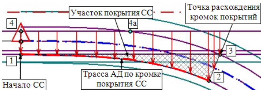
На той же кромке покрытия будет создана и целевая линия в качестве границы дополнительной полосы. Она служит для точной передачи ширины покрытия на поперечники основной трассы. Уклоны покрытия рассчитываются согласно выбранной схеме сопряжения.
