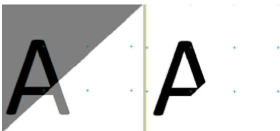
**Разность** при объединении фрагментов выполнит попиксельное вычитание растров, при этом учитывается вертикальный порядок: из нижнего растра вычитается верхний. При частичном пересечении растров нижний растр достраивается до результирующего размера черным фоном.
