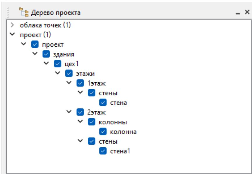
Флаг напротив названия IFC элемента позволяет управлять видимостью объектов, которым назначен данный класс или какой-либо из входящих в него. При удалении элемента кроме входящих в него также удаляются и объекты 3D геометрии, которым назначены удаляемые элементы.
