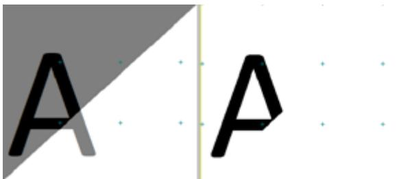
**Разность** при объединении фрагментов выполнит попиксельное вычитание растров, при этом учитывается вертикальный порядок: из нижнего растра вычитается верхний. При частичном пересечении растров нижний растр достраивается до результирующего размера черным фоном.
